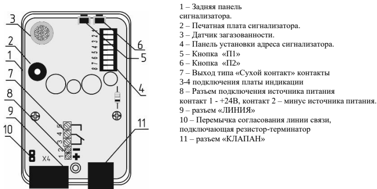
Рисунок 2. – Сигнализатор загазованности. Вид со снятой передней панелью.
