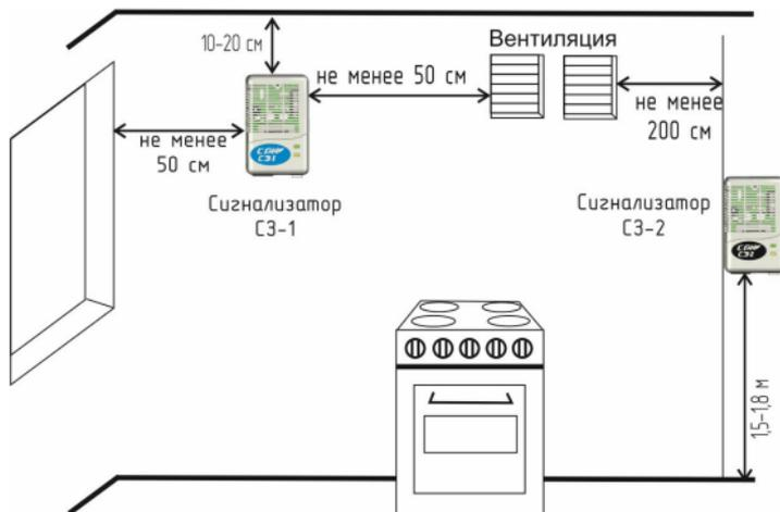
Рисунок 3 – Схема размещения сигнализаторов загазованности СГК СЗ-Х.
