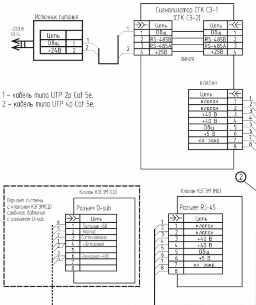
Рис. А1. Система СГК-1-х с клапаном типа КЗГЭМ.
