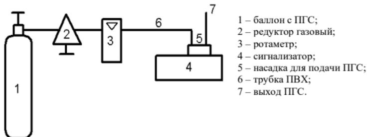
Рисунок А1 – Схема подачи ПГС
