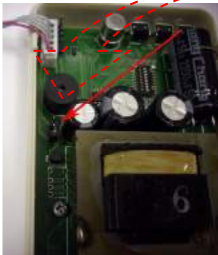
Рисунок 10. Сигнализатор СЗ-1. Запасная перемычка.
