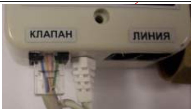
Рисунок 13. Вид на разъем RJ-45на сигнализаторе со стороны задней панели. (кабель подключен)
