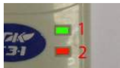
Рисунок 21. Индикаторы сигнализатора СЗ-1. Авария «обрыв клапана».
