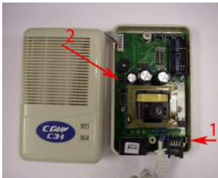
Рисунок 8. Сигнализатор СЗ-1. 1-перемычка, включающая имитатор клапана. 2 – место расположения запасной перемычки
