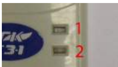
Рисунок 14. Индикаторы сигнализатора СЗ-1.
