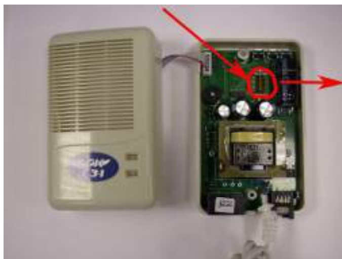
Рисунок 5. Сигнализатор СЗ-1. Вид со снятой передней панелью. Стрелками отмечено расположение микропереключателей адреса
