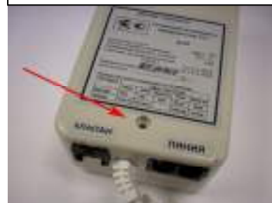
Рисунок 4. Сигнализатор СЗ-1. Крепежный винт удален.
