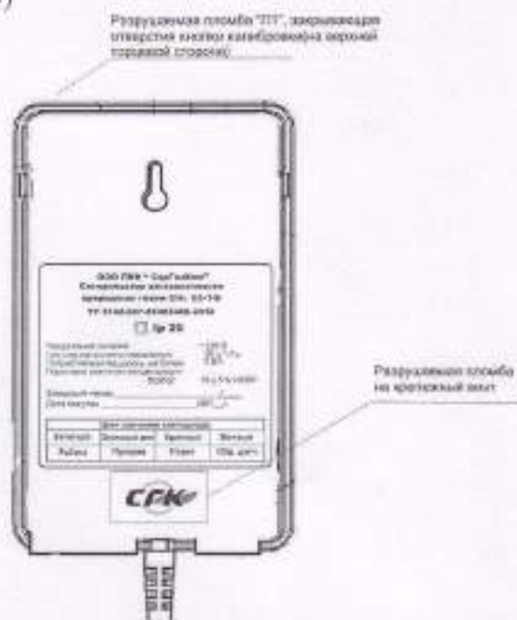
Рисунок 2 - Схема пломбировки сигнализатора от несанкционированного доступа и обозначение мест для нанесения наклеек с клеймом поверителя
