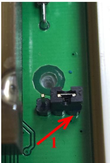
4.3.1 В этом положении (рис. 9) режим «энергонезависимой» системы отключен. Сигнализатор загазованности перекроет подачу газа (клапан КЗГЭМ закроется) при обрыве питающей линии (при обрыве или отключении питания сигнализатора 220 В). Это положение соответствует заводской настройке сигнализаторов загазованности ООО ПКФ «СарГазКом».
