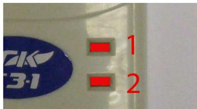
Рисунок 16. Индикаторы сигнализатора СЗ-1.
