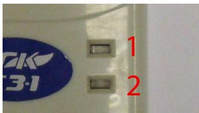
Рисунок 14. Индикаторы сигнализатора СЗ-1.
